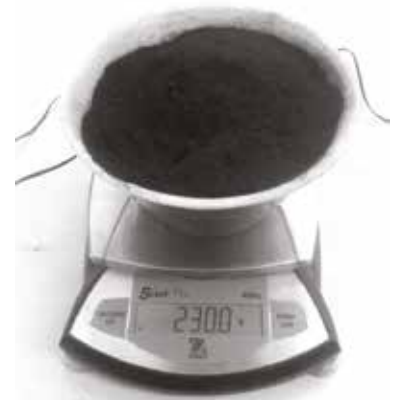
Figura 2. Ceniza de bagazo de caña, lista para sustituir al cemento.
