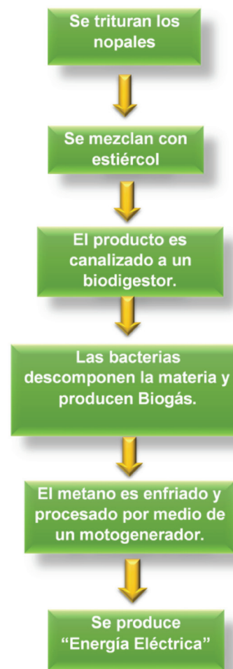
Figura 5. Figura 5. Proceso de producción de biogás para la generación de electricidad.
