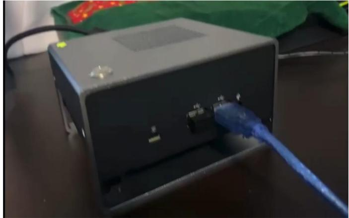
Figura 1. Prototipo diseñado para albergar el algoritmo de detección y clasificación de fallas en líneas compensadas.
