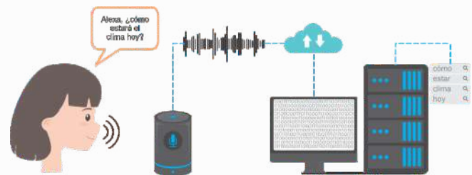
Fig. 4 Representación del audio grabado por un dispositivo de voz, enviado a un servidor a través de internet para su decodificación en máquinas de cómputo (autoría propia).
