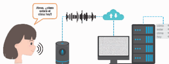
Fig. 4 Representaci3n del audio grabado por un dispositivo de voz, enviado a un servidor a través de internet para su decodificaci3n en máquinas de cómputo (autoría propia).
