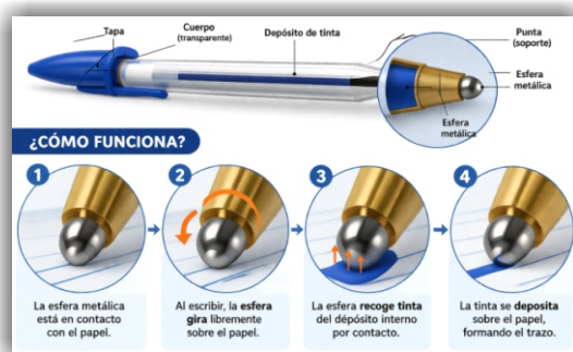
Figura 3. El funcionamiento del bolígrafo. Fuente: Elaboración propia.
